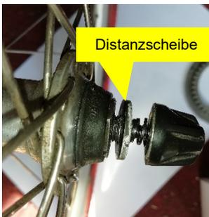
**Hinweis:** Das Halteblech ist ca. 1 mm dick. Es kann sein, dass es je nach Vorderradgabel erforderlich ist, eine auf der Achse vorhandene Distanzscheibe zu entfernen (selten).
