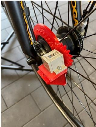
Die einwandfreie Funktion ist gegeben, wenn die Zahnräder des Stirnradgetriebes parallel in einer Flucht ineinandergreifen (Eingriffsebene). Dies kann durch Drehbewegungen des Vorderrades vorwärts und rückwärts geprüft werden.
